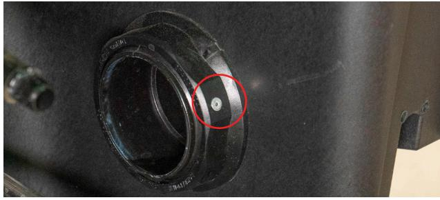
**19.** Undo the OEM outlet nut.
